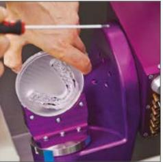
Bei der Organical Desktop 8 handelt es sich um eine hochpräzise, 5-achsige Tischfräsmaschine. Zum garantierten Trocken- und Nassbetrieb geeignet, lassen sich mit ihr alle gängigen Dentalmaterialien bearbeiten.
