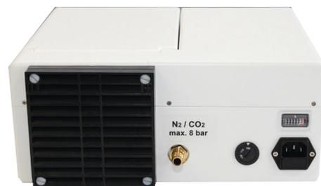
Alternativ ist das Otoflash G171 auch mit einem Schutzgasanschluß lieferbar (N<sub>2</sub>, Ar oder CO<sub>2</sub>). Damit wird die Sauerstoffinhibition an den Oberflächen verhindert, so dass diese vollständig klebfrei aushärten und ein Entfernen bzw. Abwischen der Inhibitionsschicht entfällt.
